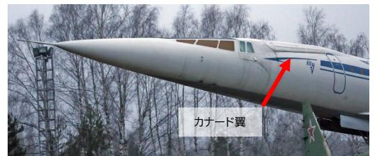
コックピット付近。窓の後ろに補助翼が格納されている
